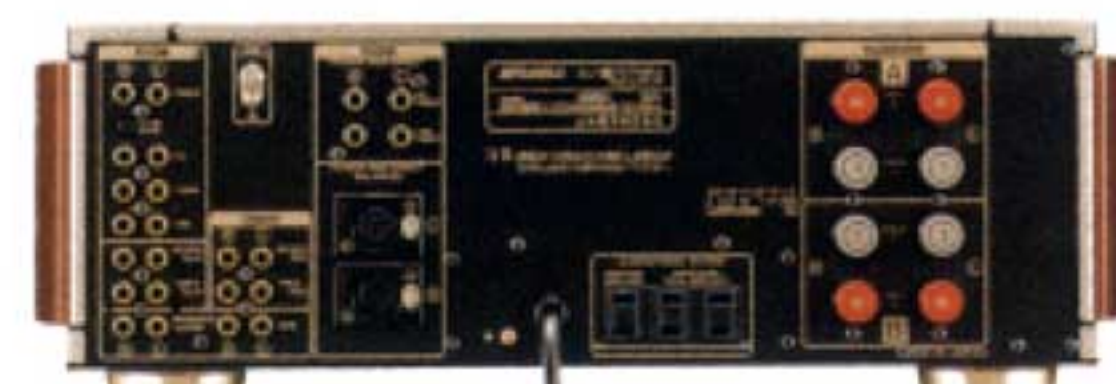
オール金メッキ入力端子、バランス入力端子を装着したリアパネルレイアウト
